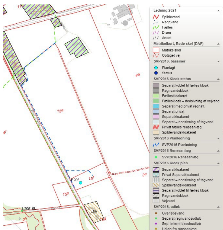
Figur 21 - Stiplede blå linje viser trace for nye ledninger
