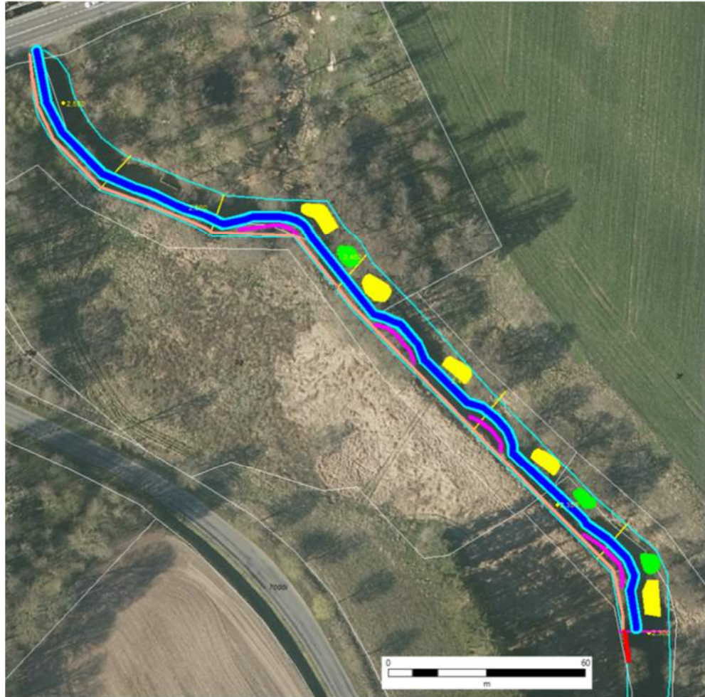
Figur 2-2 Stryget bliver ca. 225 m langt og får et vandspejlsfald på 2,0 ‰ ved normal vandføring. Forløbet bliver let slynget. På siderne af strømrenden anlægges lavninger (orange) og gydebanks (gul). Lysbrun viser en træksti og rød en anløbsplads. Lilla viser "vader", hvor man kan gå ud i åen for at følge strømrenden). Tegningen er en principskitse, og detaljerne ændres under udførelsen.
