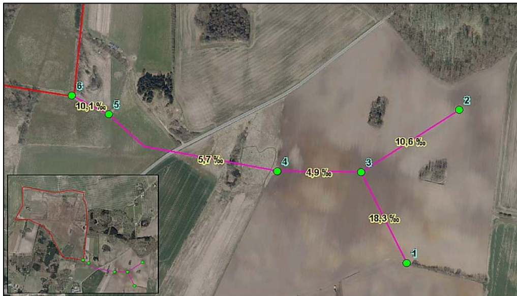
Figur 4-5. Oversigt over de opmålte drænsystemer sydvest for projektområdet, med angivelse af den relative hældning (‰) mellem udløbene fra samlebrøndene.
