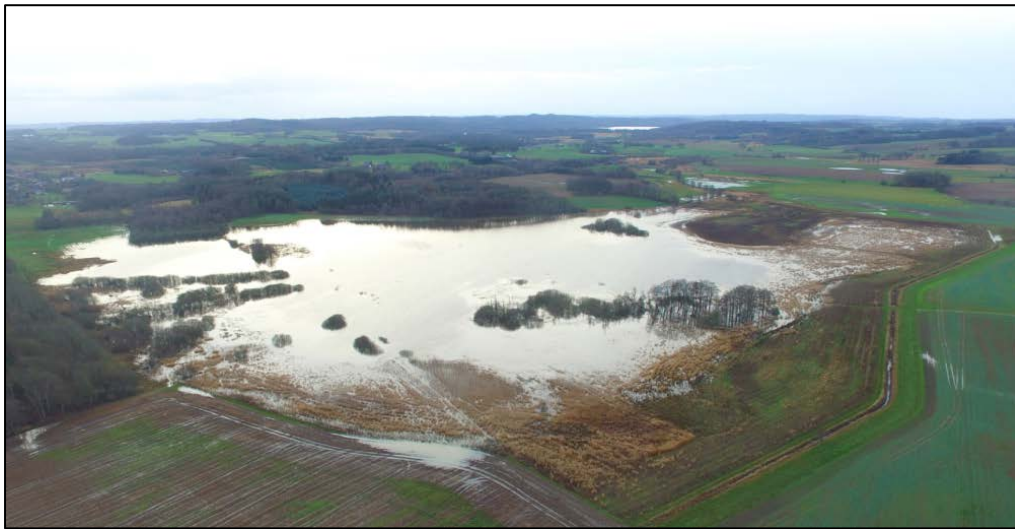
Figur 2-4. Billede fra droneoverflyvning af området i december 2015, der viser udbredelsen af "vintersøen", når pumpen er slukket.
