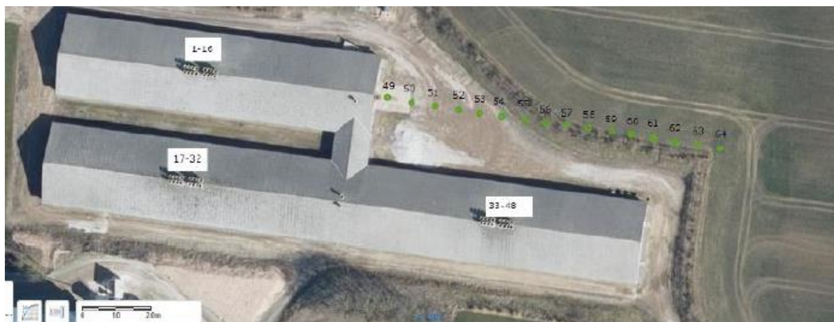
Figur 2-2 Placering af ventilationsafkast
