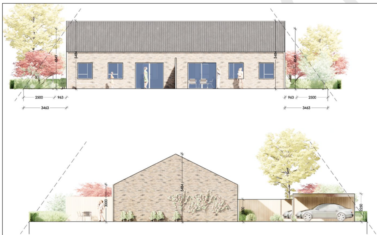
Kopi af facadetegninger fra ansøgningen af 03.09.2023. Farven på facader bliver mørkere end vist på denne illustration. Se s. 4 og 5.
