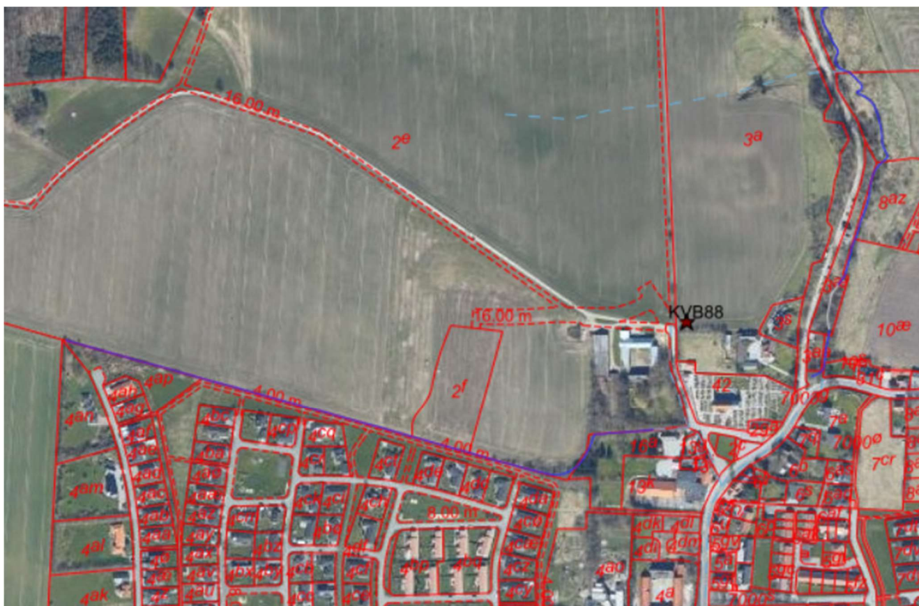
Figur 3: figuren viser den åbne grøft langs med skel til det eksisterende boligområde. Grøften er, via en ledning på den sidste del, tilsluttet ledningen i Klankballevej. Det nye vejvandsbassin KVB88 er også vist.
